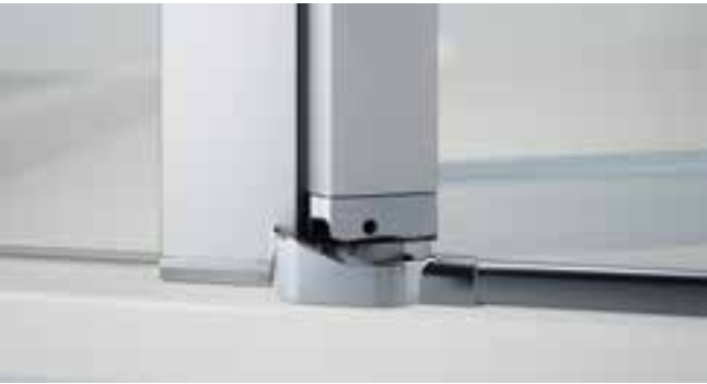
Der kraftvolle Hebesenkmechanismus hebt die Tür beim Öffnen leicht an und sorgt für einen satten Türschluss. Nebenbei beugt diese Funktion dem Verschleiß der unteren Dichtleisten vor. The powerful rise-and-fall mechanism lifts the door slightly on opening and ensures a snug closure. This function also prevents wear and tear of the lower sealing strips.
