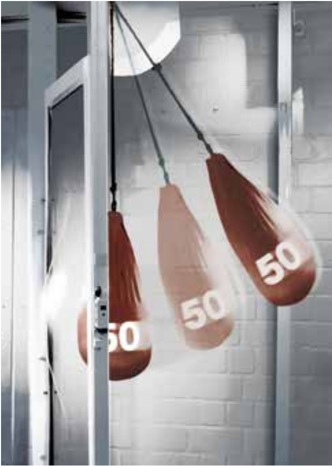
Im Dauerbelastungstest wird überprüft, ob sich eine Duschwanne auch bei ständiger Beanspruchung nicht verformt.
