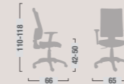
WN 10 Poltrona dattilo con braccioli regolabili mov. 10. Ergonomic typing armchair with adjustable armrests mov. 10.
